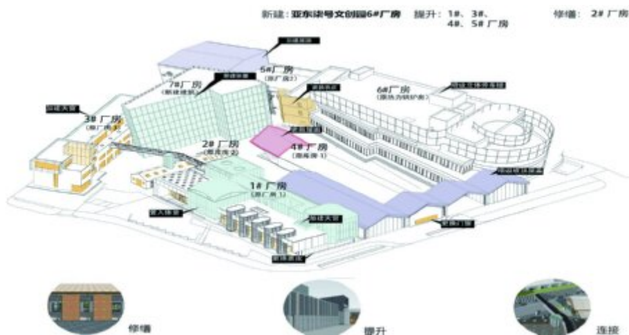
图 2-8 增设疏散楼梯和疏散连廊
